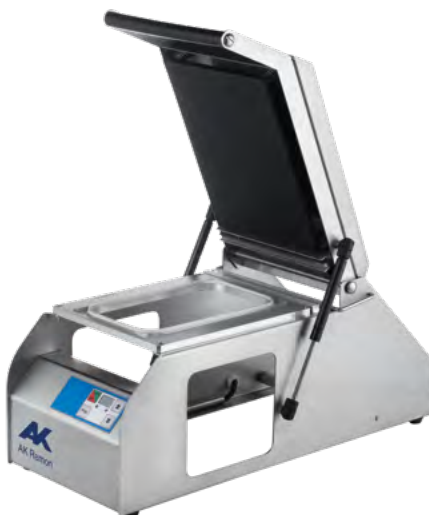
TS-160 Incluye molde 260x160 mm. (1/4 GN) Superficie máxima de sellado: 270x190 mm. Potencia: 900W
