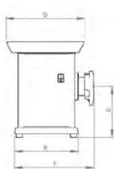
P-22. Producción ± 300 kg/h. Potencia Motor 1.5HP. P-32. Producción ± 425 kg/h. Potencia Motor 2.5HP.
